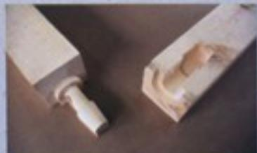
プレカットはコンピューターに連動した機械（CAM）が、継手加工します。
